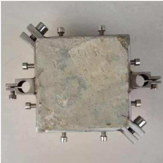
图 14 卡具式位移传感器固定装置
